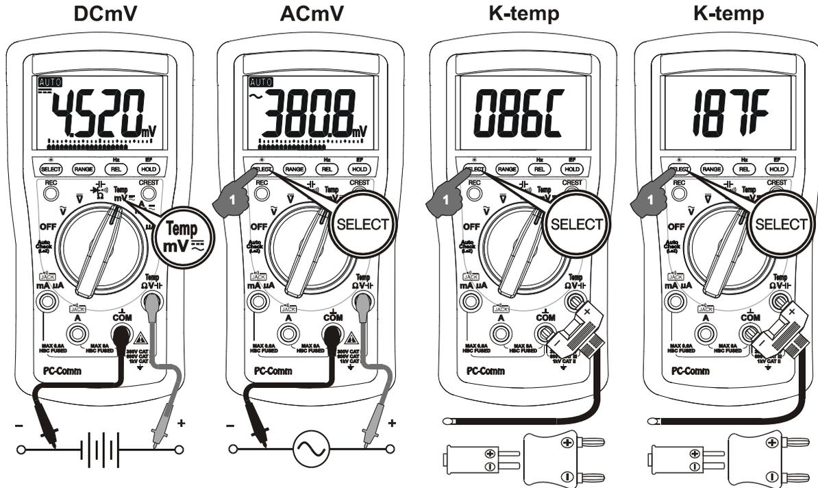
Hinweis: Stellen Sie sicher, dass der Bananenstecker des Temperaturfühlers AMD 9023 Typ K mit der richtigen  $+$   $-$  Polarität angeschlossen ist. Sie können zudem den Steckeradapter AMD 9024 (optional erhältlich) mit Bananenpins an den Eingang des Typs K verwenden, so dass auch andere Temperaturfühler-Ministecker des Typs K angeschlossen werden können.
