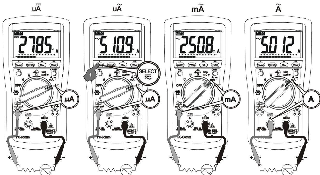
\*Hinweis: Wenn Sie Messungen in einem Dreiphasensystem durchführen, sollten Sie bei der Spannung von Phase zu Phase Acht geben, da diese bedeutend höher ist als die von Phase zu Masse. Um ein versehentliches Übersteigen der Nennspannung der Schutzsicherungen zu vermeiden, ist als Arbeitsspannung der Schutzsicherung immer die Spannung von Phase zu Phase zu berücksichtigen.
