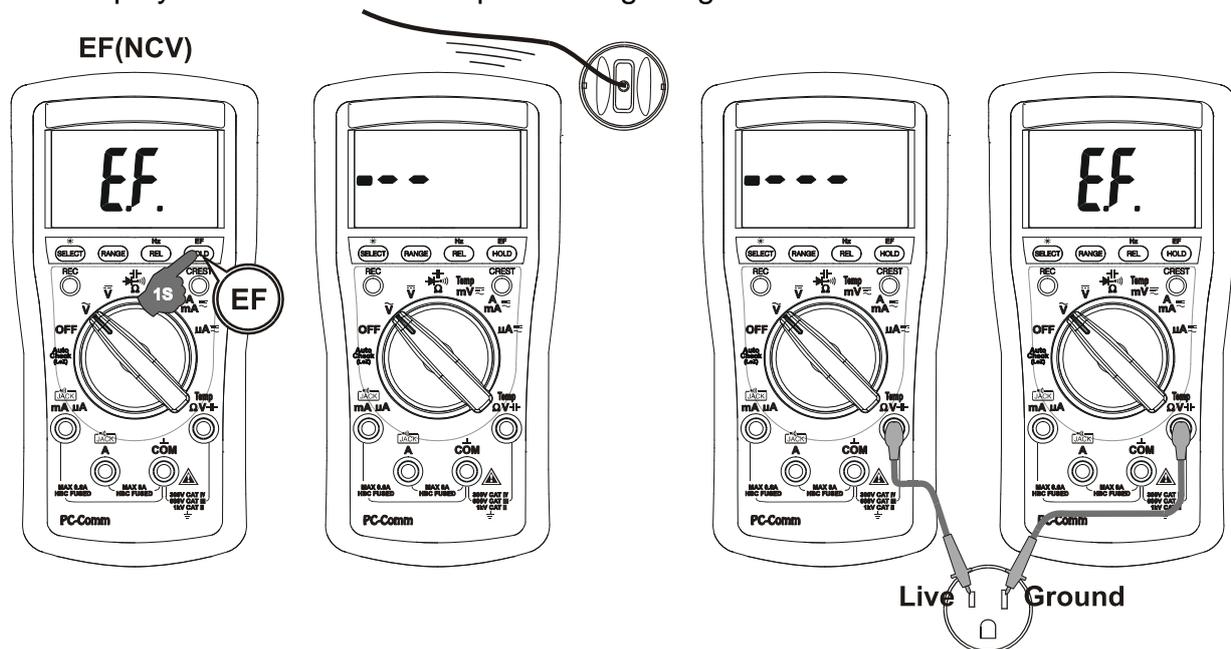
**Kontaktfreie EF-Erfassung:** Am oberen rechten Rand des Messgeräts befindet sich eine Antenne, die elektrische Felder um stromführende Leiter erfasst. Somit können stromführende Kabelverbindungen, Kabelbrüche gefunden oder zwischen Spannungs- bzw. Masse-Verbindungen unterschieden werden.
